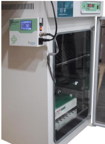
NBT101S im Inneren eines Inkubators
