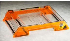
Das HR-2525 System ist ideal zur Trennung von Nukleinsäuren in Agarosegelen. Es wurde entwickelt zur Überprüfung von PCR-Fragmenten, zur RFLP- und Plasmid-Analyse, für die Field Inversion Gel Elektrophorese (FIGE), zur Trennung von genomischer DNA sowie Elektrophoresen, die eine Rezirkulation benötigen. Bis zu 50 x 8er PCR-Streifen können innerhalb von 15 Minuten überprüft werden.
