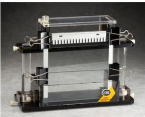
Das JVD-80 System ermöglicht die schnelle Analyse (< 90 Minuten) von Protein- und Nukleinsäureproben in einem 16 x 18 cm Polyacrylamidgel mit einer hohen Reproduzierbarkeit. Durch die Möglichkeit, das System von 16 cm auf 42 cm bzw. 62 cm zu vergrößern, lässt sich die Auflösung um den Faktor 2,5 erhöhen.
