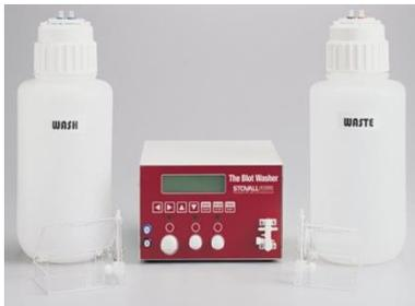
Der programmierbare Blot Washer wurde zur Automatisierung von Blotting-Prozessen entwickelt und ermöglicht die Blot-Entwicklung mit denselben Parametern, wodurch Abweichungen deutlich reduziert werden. Er automatisiert die Waschschriffe, Inkubation und das Dispensieren von Reagenzien, einschließlich des Sekundärantikörpers.
