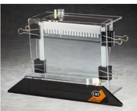
Das VCV System wurde für die hochauflösende und schnelle Analyse von Protein- und Nukleinsäuren in 18 x 22 cm Gelen (Agarose und Polyacrylamid) entwickelt. Es ist damit besonders geeignet für Mapping- oder Blotting-Anwendungen.
