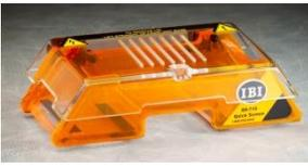
Das QS-710 System wurde für die schnelle lineare Auftrennung von Nukleinsäuren entwickelt. Es benötigt nur einen minimalen Aufbauaufwand und ermöglicht eine hervorragende Auflösung der Banden und einheitliche Bandenbewegung für genaue Ergebnisse. Das QS-710 eignet sich für eine Vielzahl von Anwendungen, die eine schnelle Auftrennung (30 Minuten oder weniger) erfordern, wie z.B. Fragment- und Rekombinationsanalyse.
