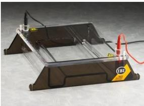
Das JSB-96 System eignet sich zur schnellen Auftrennung von Proben mit geringen Agarosemengen (100 ml). Es ist ideal für PCR-, RFLP und Plasmidanalyse. Das JSB-96 Mikrotestplatten-Format ermöglicht die Analyse von Proben sowie Markern und Negativkontrollen in weniger als 90 Minuten. Die Kämme des Mikrotestplatten-Formats wurden für eine schnelle Beladung des Gels mit einer Multikanal-Pipette entwickelt, lassen aber auch Platz für Molekulargewichts-Marker.
