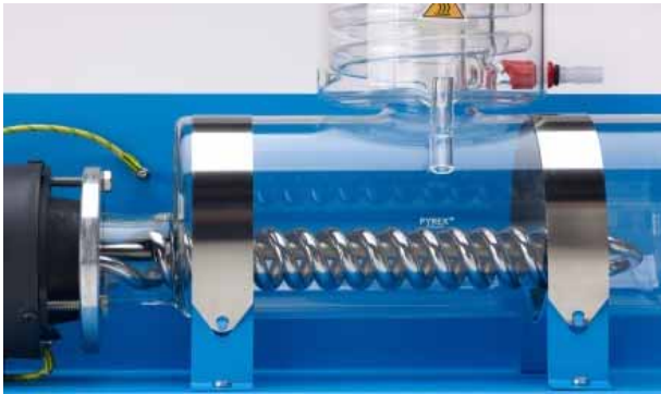
Heizelement und Boiler
