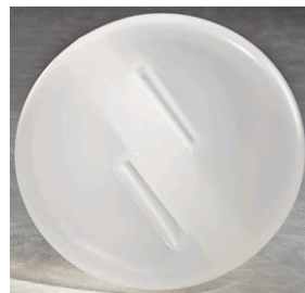
Halb-Schikane Kolben mit 2 Schikanen • Wirbelbewegung
