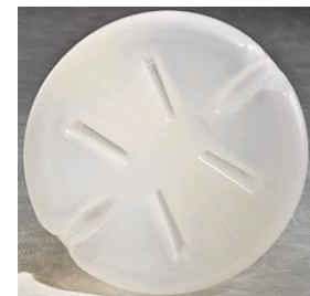
Voll-Schikane Kolben mit 6 Schikanen • Propellerbewegung
