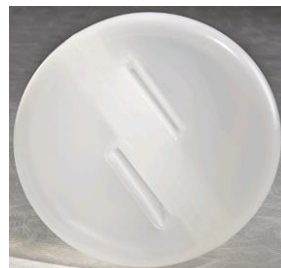
Halb-Schikane Kolben mit 2 Schikanen • Wirbelbewegung
