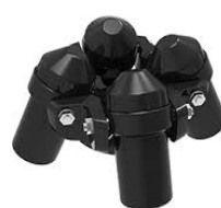
CR-43-100 4 x 100 ml Ausschwingrotor mit Bio-Schutzkappe, RCF 3164 g
