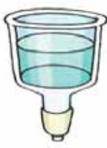
Sie sollten sicherstellen, dass die Porosität der Sinterscheibe für die gewünschte Anwendung geeignet ist. Sinterfilter mit der Porosität 0 sind für die Grobfiltration, während eine höhere Zahl eine feinere Filtration anzeigt.
