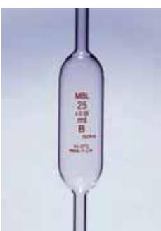
**Vollpipette, MBL®, Klasse AS, mit Zertifikat, ISO 648, mit individueller Seriennummer, Auslaufpipette**
