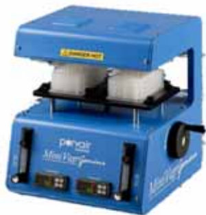
MiniVap™ Gemini mit zwei Köpfen zur individuellen Evaporation
